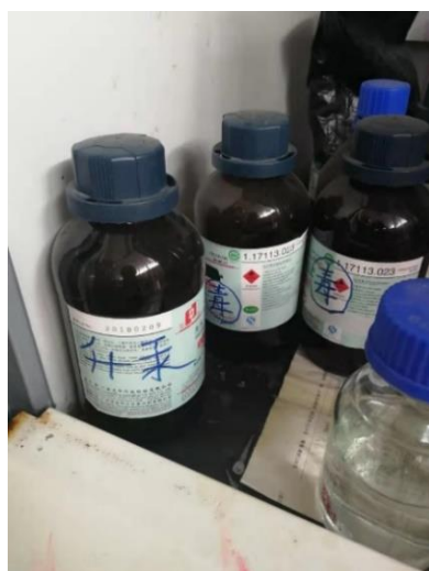
理科楼 C803—实验室存放剧毒试剂 (此为配置液，未标明配置时间和浓度)
